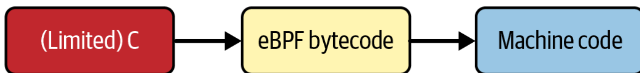
Рисунок 3-1. Исходный код C (или Rust) компилируется в байт-код eBPF, который затем либо JIT-компилируется, либо интерпретируется в собственные инструкции машинного кода.
