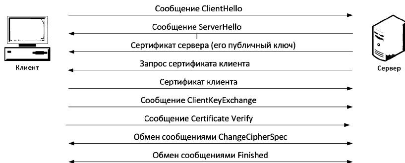
Рис. 70. Процесс работы протокола SSL
