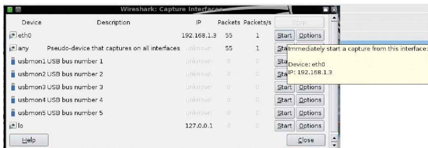
Рис. 5. Запуск прослушивания интерфейса в Wireshark в BackTrack
